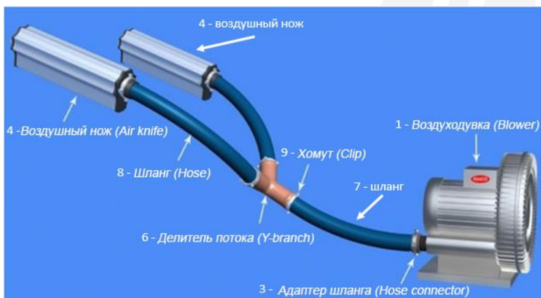
Рис.1. Схема подключения воздушных ножей (2 шт) к воздуходувке.
