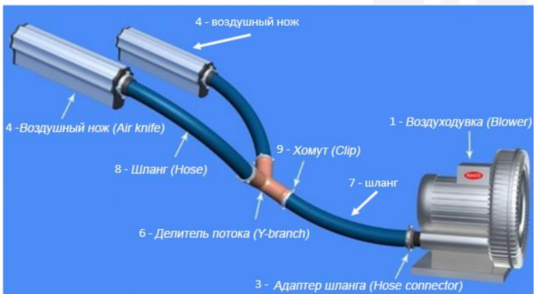
Рис.1. Схема подключения воздушных ножей (2 шт) к воздуходувке.
