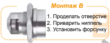
Форсунка Гайка Ниппель
