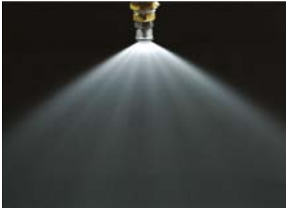
Сечение распыла Полоконусное распределение
