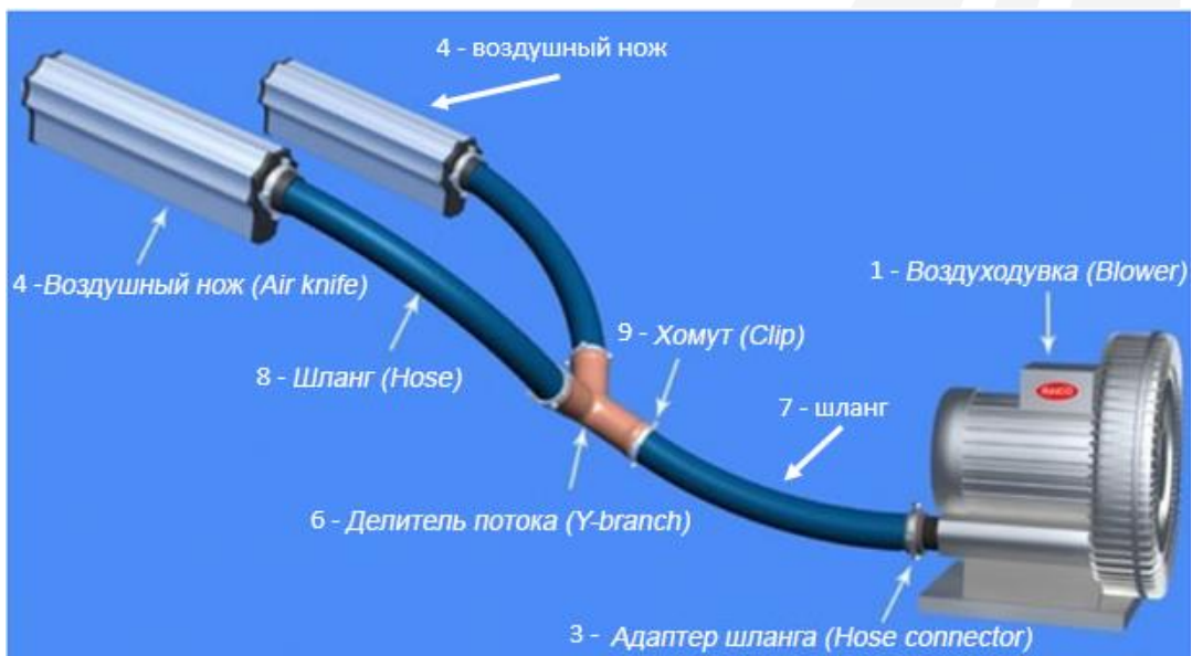
Рис.1. Схема подключения воздушных ножей (2 шт) к воздуходувке.
