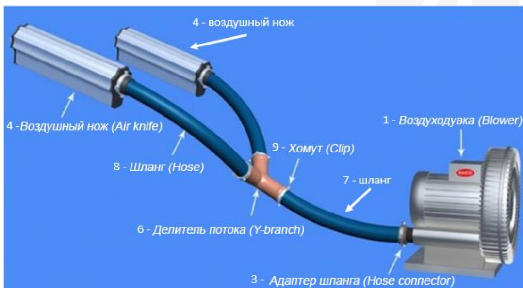
Рис.1. Схема подключения воздушных ножей (2 шт) к воздуходувке.
