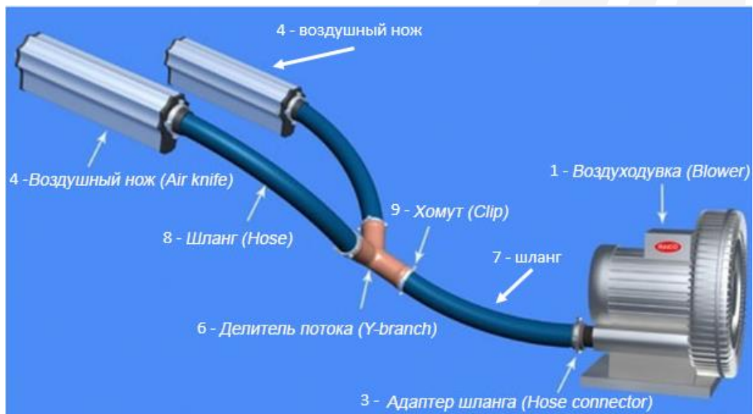
Рис.1. Схема подключения воздушных ножей (2 шт) к воздуходувке.
