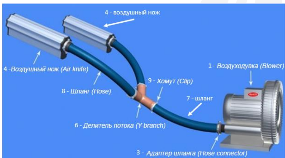
Рис.1. Схема подключения воздушных ножей (2 шт) к воздуходувке.
