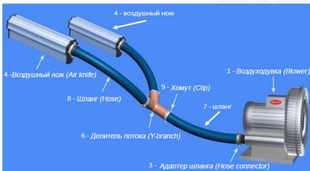
Рис.1. Схема подключения воздушных ножей (2 шт) к воздуходувке.
