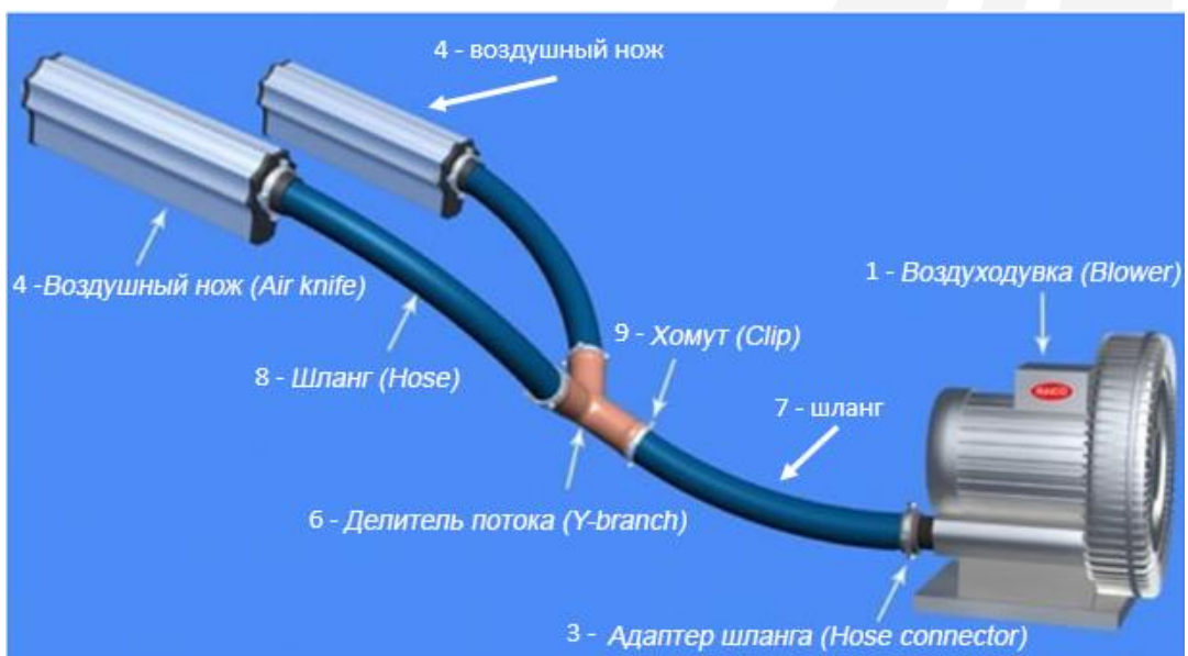
Рис.1. Схема подключения воздушных ножей (2 шт) к воздуходувке.
