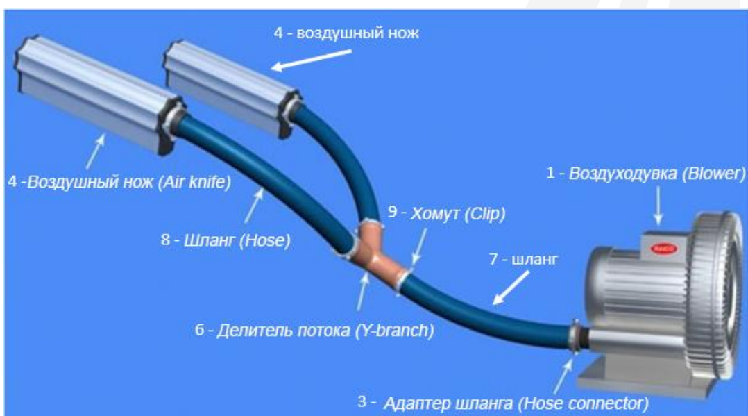
Рис.1. Схема подключения воздушных ножей (2 шт) к воздуходувке.
